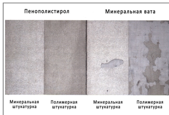
Фото 1. Вид западных стен из ячеистого бетона с различными WDVS после 2- лет наблюдений[17]
